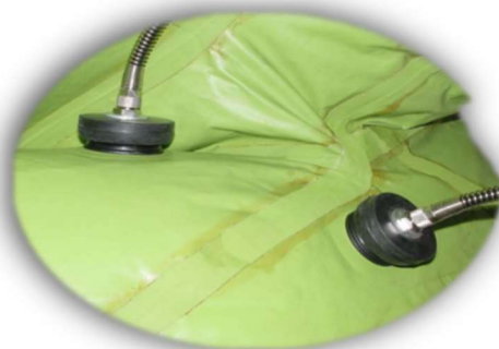
Füllleitung und Prüfleitung an CSA
